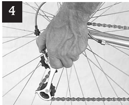
4 Rotate the derailleur body rearward.
